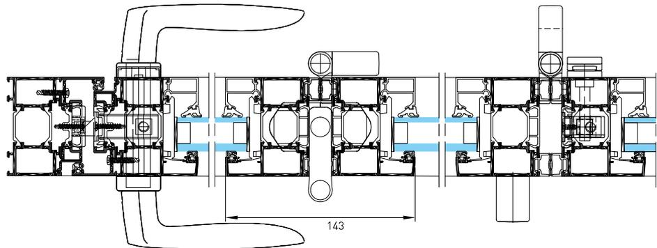
De 2 à 10 vantaux en angle sortant, ouverture intérieure ou extérieure avec configuration identique
