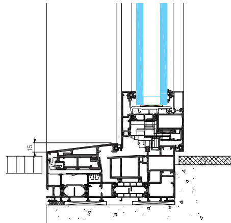
Coupe verticale - partie ouvrant, seuil encastré
